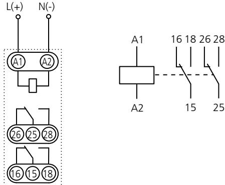
**ВНИМАНИЕ:** Для исключение сбоев в работе реле при коммутации индуктивной нагрузки (электромагнит, электромагнитный клапан и др.), подключите непосредственно к клеммам нагрузки помехоподавляющую цепь в виде последовательно соединенных резистора 100...200 Ом 2Вт и неполярного конденсатора 0.1...0.22 мкФ 630В.
